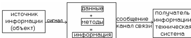
Информация передаётся в форме **сообщений** от некоторого **источника** информации к её **приёмнику** посредством **канала связи** между ними. Источник посылает **передаваемое сообщение**, которое **кодируется в передаваемый сигнал**. Этот сигнал посылается по **каналу связи**. В результате в приёмнике появляется **принимаемый сигнал**, который **декодируется** и становится **принимаемым сообщением**.
